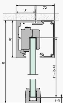
**Montaggio a soffitto con anta fissa**
